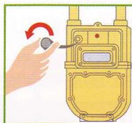
2 復帰ボタンのキャップを手で左に回し、キャップを外してください。
