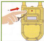
3 復帰ボタンを奥までしっかり押して、表示ランプが点灯したらすぐに手を離す。(復帰ボタンが元に戻り、赤ランプが再点滅します。その後、キャップを元に戻しておきます。)
