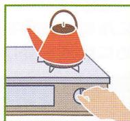
器具栓を閉じるか、運転スイッチを切り、すべてのガス機器を止めてください。屋外の機器も忘れずに。使っていないガス栓は閉まっていることを確認してください。このときメーターガス栓は閉めないでください。
